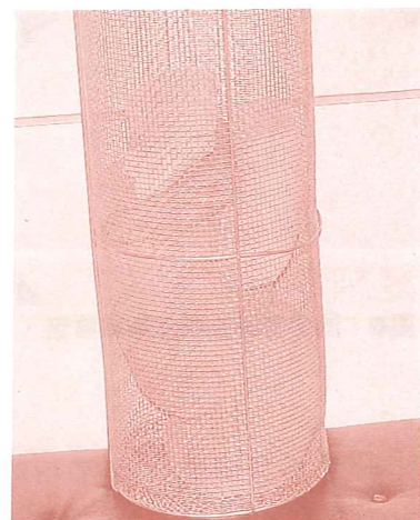
圖③：置於桶狀網籃中之消毒包。消毒時將整桶置入高壓滅菌消毒鍋中。
